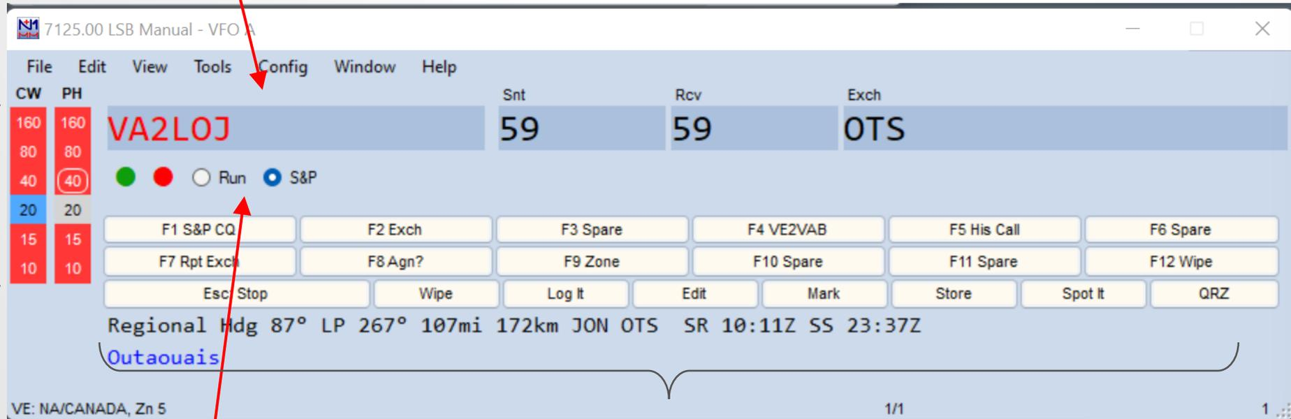
Cliquer pour choisir bande et mode (synchronisé avec le radio si la communication fonctionne)
